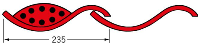
Mit einem Lüftungsquerschnitt von ca. 12 cm<sup>2</sup>.
