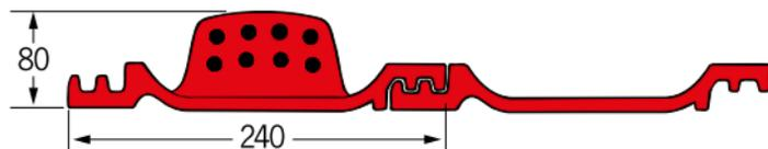
Mit einem Lüftungsquerschnitt von ca. 9 cm<sup>2</sup>
