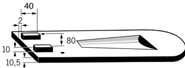
Mit einem Lüftungsquerschnitt von ca. 5 cm<sup>2</sup>.
