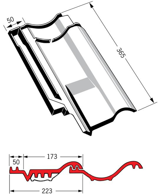
Mit einem Lüftungsquerschnitt von ca. 9 cm<sup>2</sup>.
