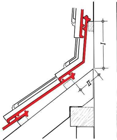
Der Knickdachziegel negativ kann mit Winkelgrößen von 200° bis 250° geliefert werden. Bei den einzelnen Winkelgrößen werden jeweils verschiedene Lattenabstände benötigt.
