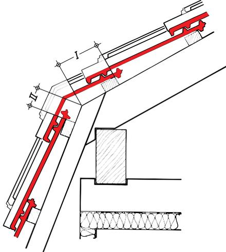
Der Knickdachziegel positiv kann mit Winkelgrößen von 110° bis 160° geliefert werden. Bei den einzelnen Winkelgrößen werden jeweils verschiedene Lattenabstände benötigt.
