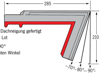
Pultdachziegel werden auf Dachneigung gefertigt
