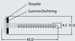
CU-Schraube zur Befestigung
