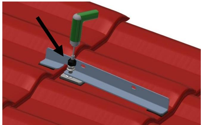
6. Die Solarhalter Lochschiene an die Systemschiene setzen und mit den M8 Schrauben und Muttern befestigen.
