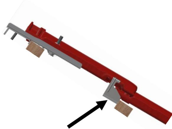
5. Die Systemschiene hat eine Neopren Auflage. Mit der Auflage nach unten, wird die Systemschiene jetzt auf die Schraube des Trägerziegels gesteckt und mit einem 15 mm Schlüssel die M10 Mutter anziehen, bis die Systemschiene nicht mehr seitlich kippen kann. Dabei ist es nicht erforderlich das die Systemschiene auf der Mutter der Grundplatte aufliegt.
