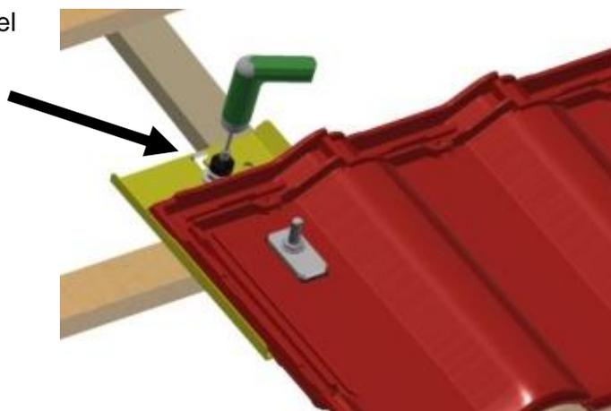
4. Dann wird der Dachziegel mit einem Sturm-Clip gesichert. Befestigen Sie den Sturm-Clip am unteren Ende des Dachziegels und schlagen Sie den Sturm-Clip in die Tragplatte.
