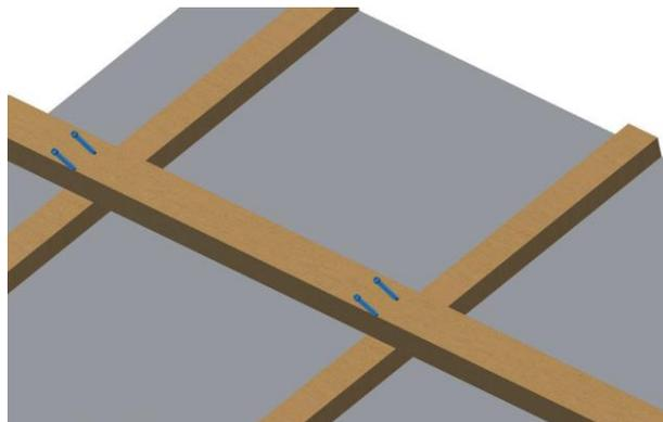
2. Den vormontierten Dachziegel mit der Meyer-Holsen Grundplatte auf die Traglatte hängen.
