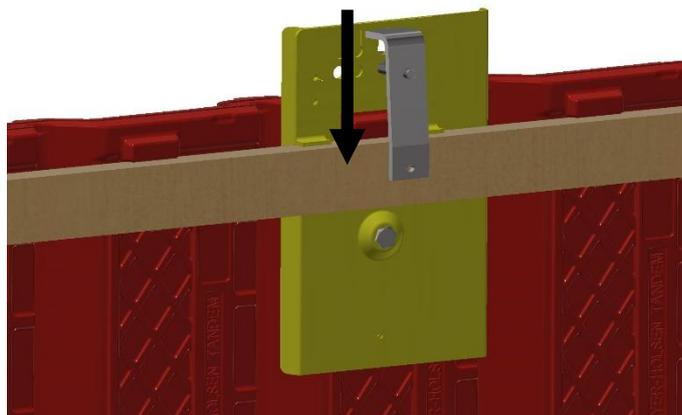
3. Anschließend mit einem 13 mm Schlüssel die Schraube an der Meyer-Holsen Grundplatte anziehen, bis die Klemme an der Unterseite der Latte anliegt.
