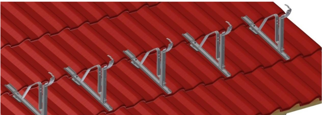
4. Lege das Schneefanggitter nach Möglichkeit in die unterste Position. Den Verschluss auf den Halter setzen und mit Druck in dem vorgesehenen Loch einrasten lassen.
