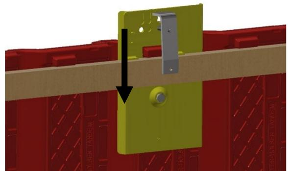
Anschließend mit einem 13 mm Schlüssel die Schraube an der Meyer-Holzen Grundplatte anziehen, bis die Klemme an der Unterseite Der Latte anliegt.
