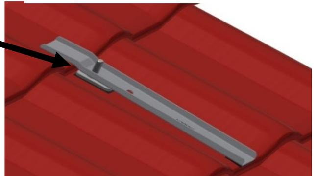
Den Schneefanghalter über das Gewinde der Schraube in die Systemschiene legen und beides mit der M10 Mutter befestigen. Dabei ist nicht erforderlich das die Systemschiene auf der Mutter der Grundplatte aufliegt.
