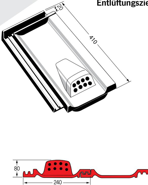
Mit einem Lüftungsquerschnitt von ca. 9 cm<sup>2</sup>
